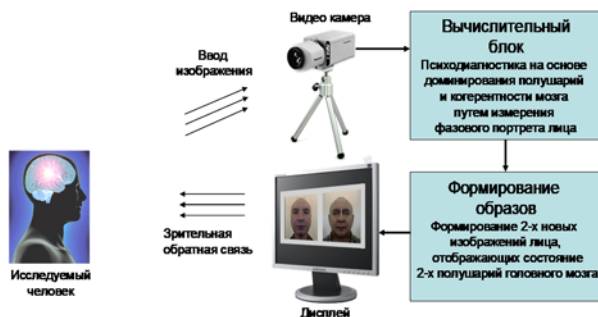
Рисунок 2. Схема аппаратно-программного комплекса «ПОРТРЕТ» для реализации предложенного метода объективной психодиагностики.
