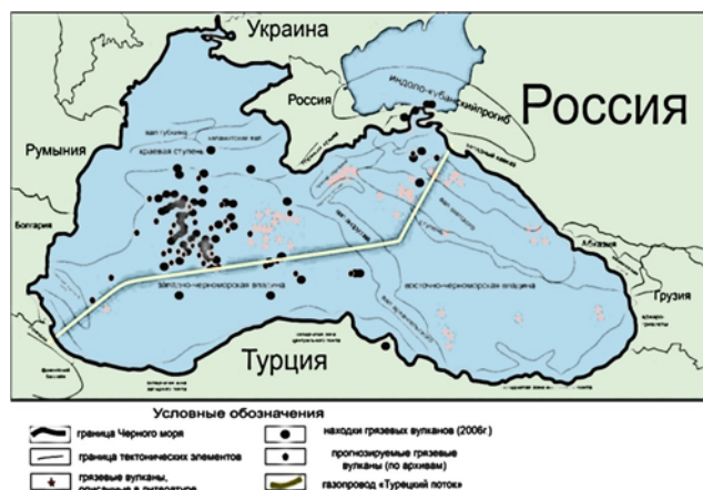
Рис. 1. Схема расположения газопровода «Турецкий поток» в Черном море с нанесенными тектоническими элементами и грязевыми вулканами Источники: [4]
